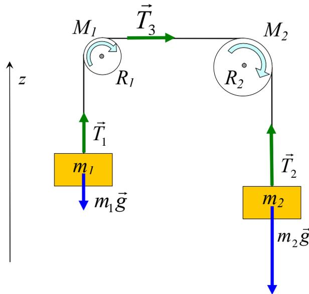
Comme le fil ne glisse pas, ces vitesses angulaires  $\omega_1$  et  $\omega_2$  sont liées à la vitesse  $V$  des mobiles:  $\omega_1 = V/R_1$  et  $\omega_2 = V/R_2$ . Les équations (24) deviennent alors:
