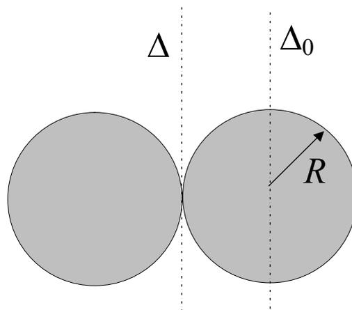
Soit  $M$  la masse du système et  $R$  le rayon des sphères. On connaît le moment d'inertie  $I_0$  d'une sphère par rapport à l'axe  $\Delta_0$  passant par le centre :
