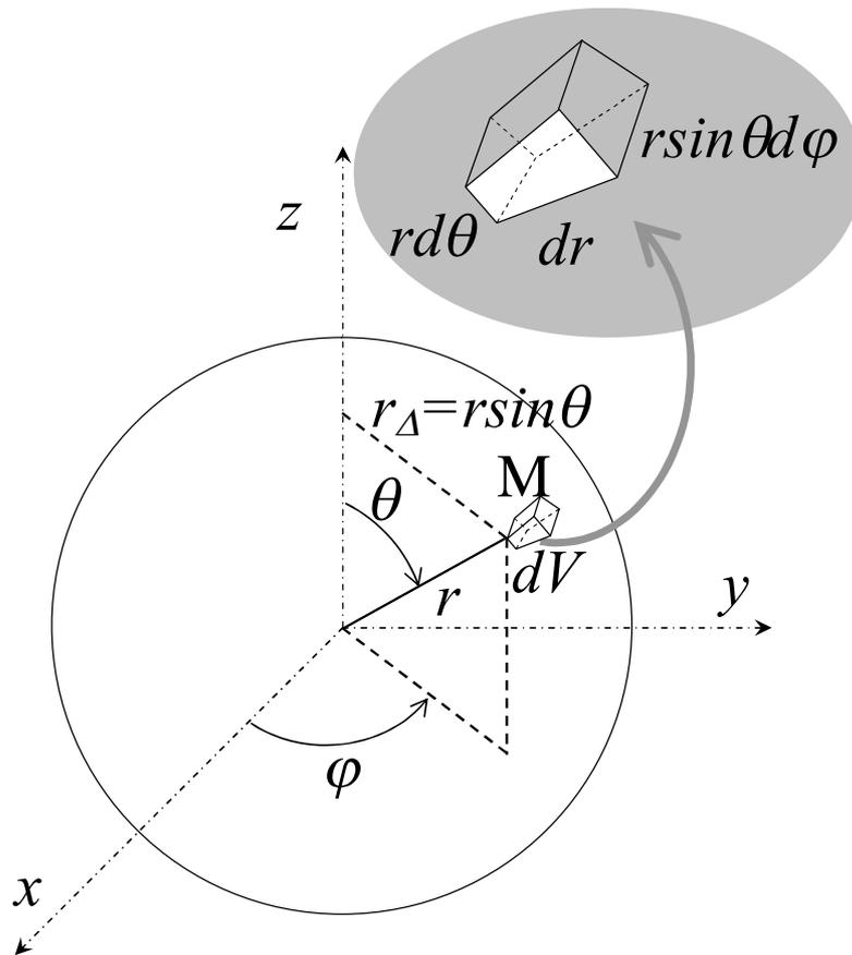
Plaçons-nous tout d'abord en coordonnées sphériques  $r, \theta, \varphi$  et calculons le moment d'inertie par rapport à l'axe vertical Oz. La distance à l'axe OZ est  $r_{\Delta}=r\sin\theta$ . Un petit élément de volume  $dV=r^2\sin\theta dr d\theta d\varphi$  contient une petite masse  $dm=\rho dV$ . On a alors :
