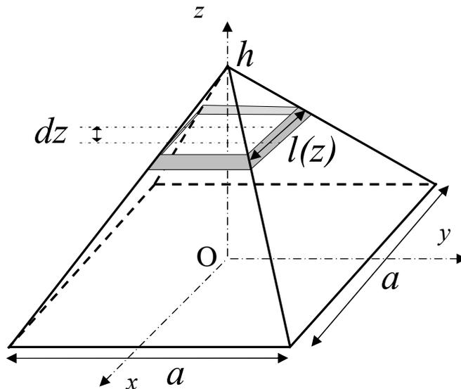
Soit  $a$  le côté de la base de la pyramide et  $h$  sa hauteur. Par symétrie, on peut affirmer que le centre d'inertie G se trouve sur l'axe vertical  $Oz$  de la pyramide. Reste à trouver sa position  $z_G$ . Pour cela, découpons la pyramide en petites tranches d'épaisseur  $dz$  entre  $z$  et  $z+dz$  parallèles au plan horizontal  $Oxy$ . Chaque tranche est un carré de côté  $l(z) = (h-z)a/h$ . On a donc :
