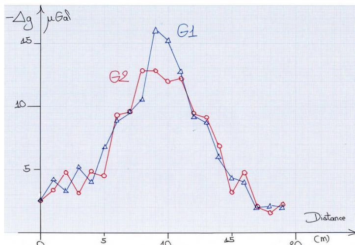
On a représenté les données sur le graphe ci-dessus. On constate que les anomalies sont semblables sur les deux profils. On peut donc considérer qu'il s'agit d'une **cavité cylindrique**.
