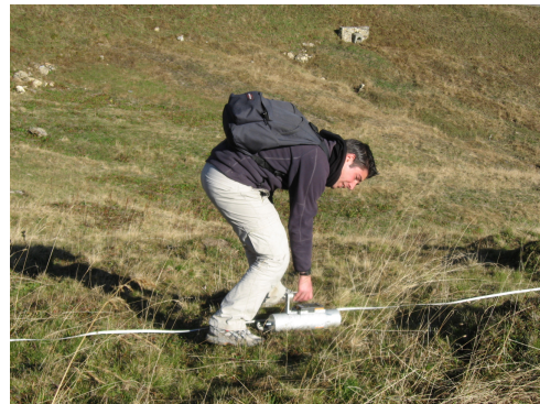
Fig. 2 : Mesure effective du débit de dose gamma (Cornet de Roselend, 2007).
