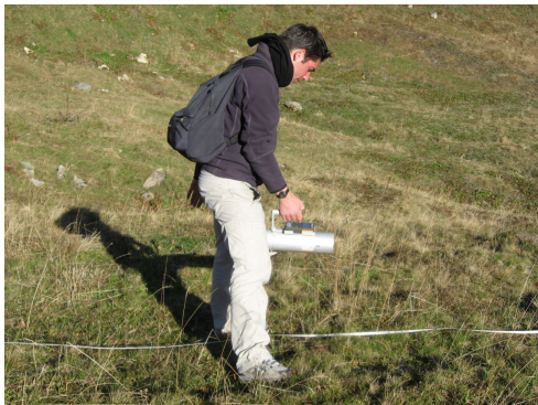
Fig. 2 : Mesure effective du débit de dose gamma (Cornet de Roselend, 2007).
