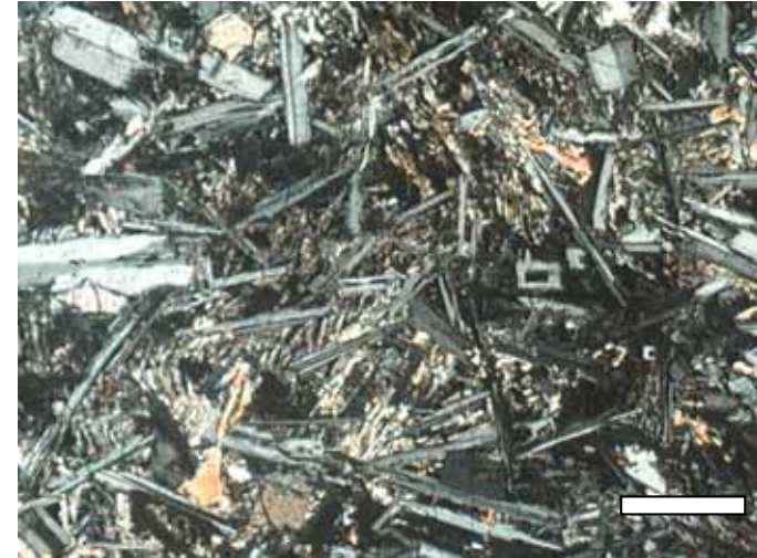
textures de trempe (plagioclase et clinopyroxène (échelle = 100 \mu ))
