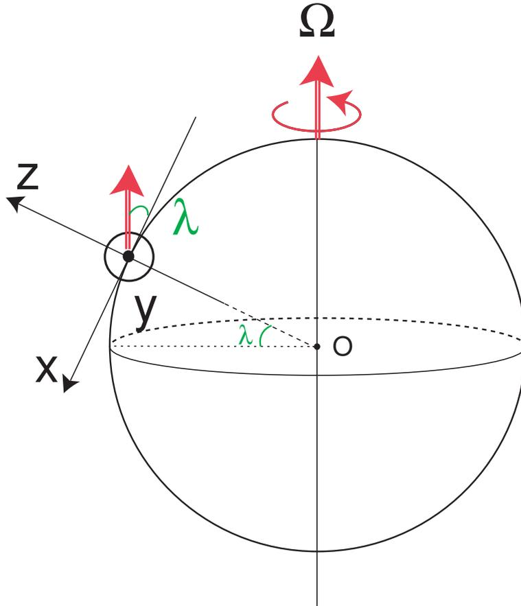
2) Le point se déplace alors à une vitesse  $\vec{v} = (v_x, v_y, 0)$ . Déterminer l'accélération de Coriolis ressentie.
