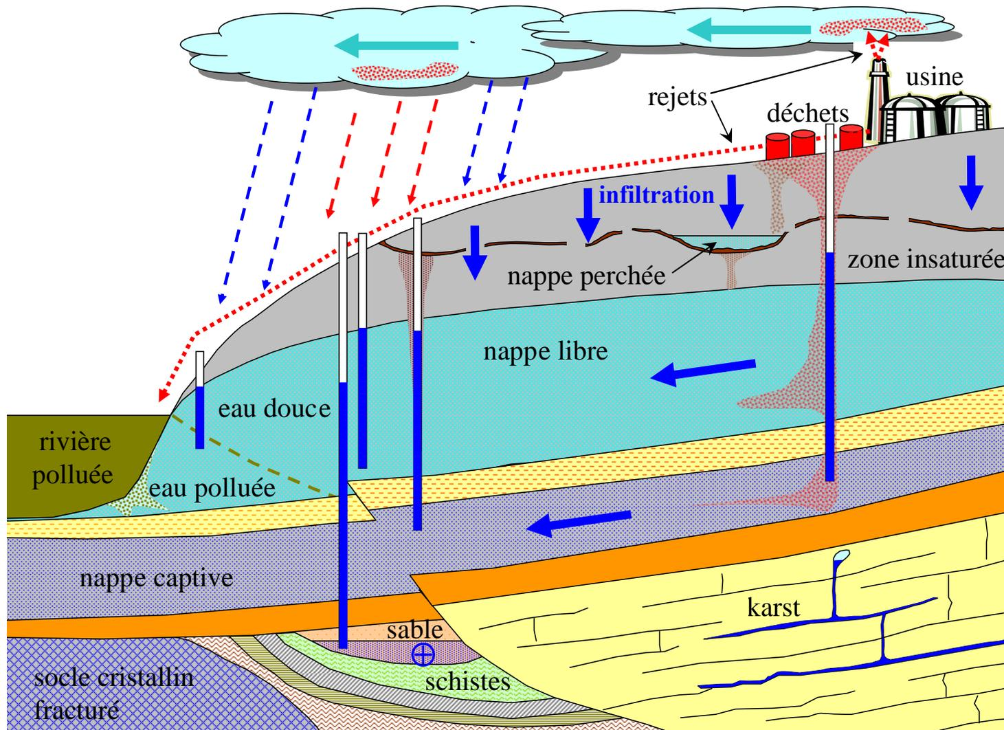
Figure 2.2. Quelques scénarios de contamination des réservoirs du sous-sol.
