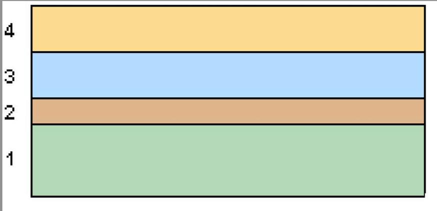
Les couches sédimentaires se déposent d'abord à l'horizontale, les couches se sont superposées les unes aux autres, ce qui implique que celle qui est en dessous d'une autre est plus vieille que cette dernière.
