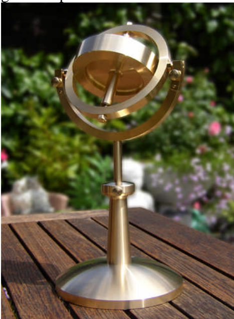
Figure 3.7. Notre gyroscope de démonstration.
